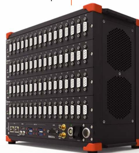
**Étage DualCoreADC®** : 8 amplificateurs isolés avec double convertisseur 24bits, 160dB de gamme dynamique, 200kHz/voie, au choix parmi :
